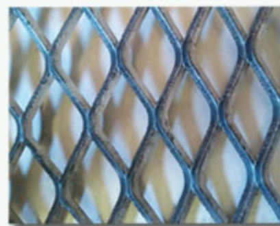
Chapa expandida espessura 1/4" (6,35mm) malha 38x75mm
