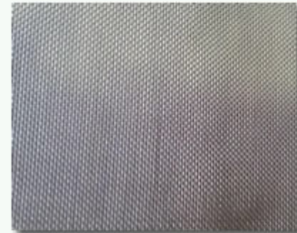
Tela Tecido Inox Malha: 50 ( Abertura: 0,32 mm.) Fio: 34 ( Diam. 0,18 mim.)
