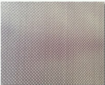
Tela Tecido Inox Malha: 40 (Abertura: 0,41 mim ) Fio: 32 ( Diam. 0,23 mim )
